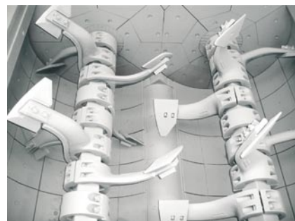
Wnętrze mieszarki dwuwałowej TDZ
